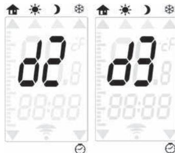
Il giorno della settimana e le ore da programmare vengono visualizzate sullo schermo. La parte inferiore dello schermo indica l'intervallo di tempo da programmare. Utilizzate **+** per programmare la posizione di confort e **-** per programmare la posizione notturna.
